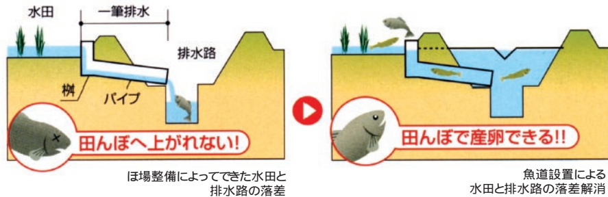
写真T2-2-1 魚道(魚のとおり道)の設置により排水路の水位は階段状に田んぼの高さまで上がり、琵琶湖から上がった魚は、一筆排水を使って田んぼへ入り産卵することができます。
